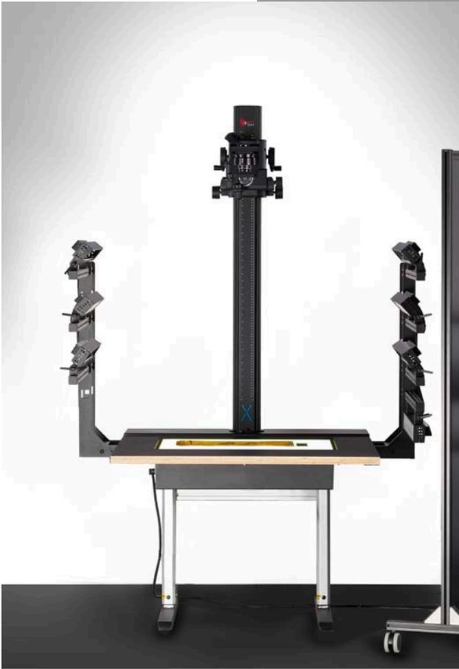
Mit dem Multispektralsystem lassen sich verblasste Schriften, Unterzeichnungen, Materialkombinationen in den Schreib-, Zeichen- und Malmitteln oder Spuren organischer Alterungsprozesse sichtbar machen. Dies ermöglicht die Überprüfung von Vorlagen auf deren materielle Vollständigkeit ebenso wie detaillierte Echtheitsanalysen.
