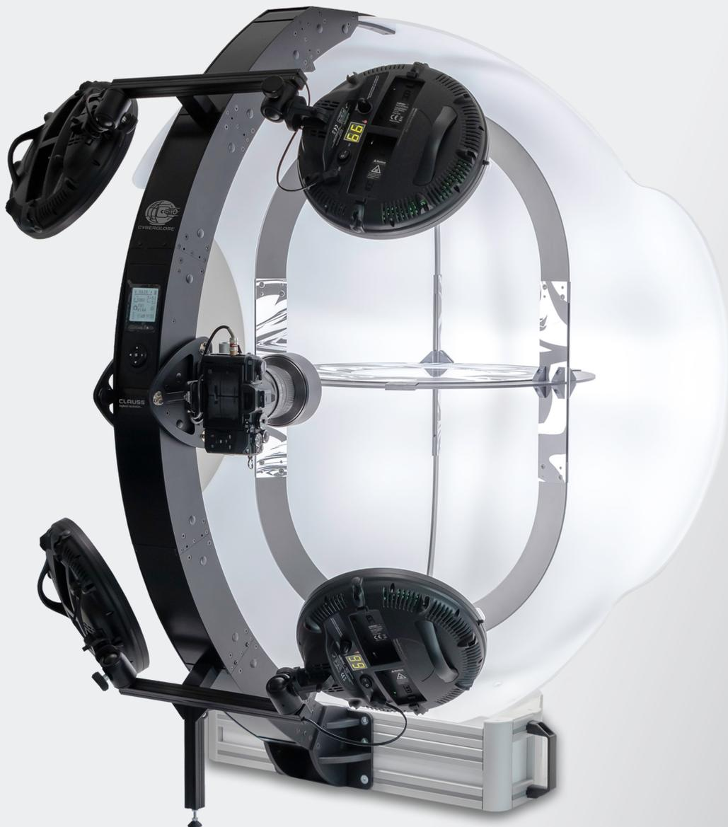
Der CYBERGLOBE ist der weltweit erste 3D-Scanner, der durch seinen patentierten, transparenten Objektträger eine nahtlose, vollständige und automatisierte Erfassung von Objekten aus jedem Blickwinkel garantiert. Diese revolutionäre Technologie setzt neue Maßstäbe in der Objektdigitalisierung und kombiniert beispiellose Präzision mit herausragender Benutzerfreundlichkeit und Vielseitigkeit.
